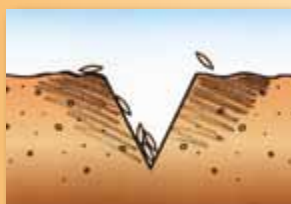
7. Tradiční sečí stroje vytváří drážku ve tvaru V, kde je nedokonalý styk osiva s půdou
