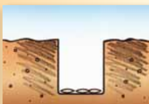
8. TriWave vytváří čistou a čtvercovou drážku – širší osu pro maximální styk osiva s půdou
