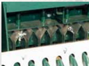
2. Osivo je umístěno přímo do drážky
