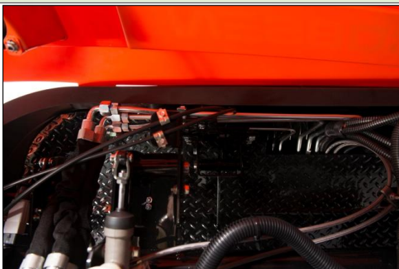
Ocelové trubky – jednoduchá údržba, omezení úniku hydr. kapaliny
